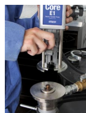
3. Deslice el motor eléctrico para sacarlo
